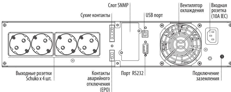
Задняя панель дополнительного батарейного модуля для ИБП IPRON INNOVA показана на следующем рисунке:
