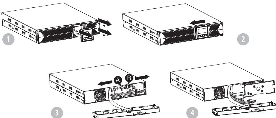
5. Выньте батарейный блок из корпуса ИБП.
