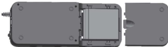
**Шаг 3:** Аккуратно извлеките батарею, отключив контактные провода устройства. Используйте батарею того же типа. Утилизируйте старую батарею надлежащим образом.
