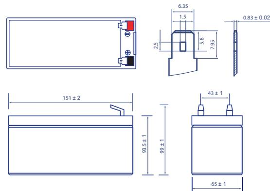
РАЗМЕРЫ | Клемма T1 (размеры в мм)
